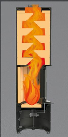
Lenkung der Heizgase durch Schamottekern: effiziente Langzeit-Wärmespeicherung
