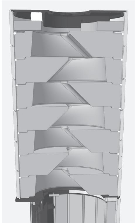
Fig. 3.29 Montage du tuyau de fumée
