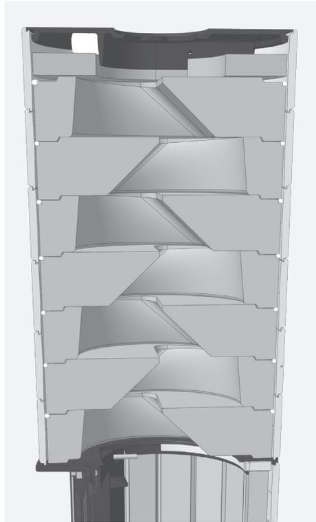
Fig. 4.8 Parcours du gaz de chauffage dans le tuyau de fumée
