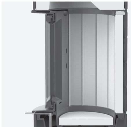
Fig. 3.5 Revêtement de la chambre de combustion
