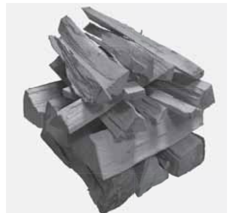
Abb. 4.10 gesamte Holzaufgabe beim Anheizen
