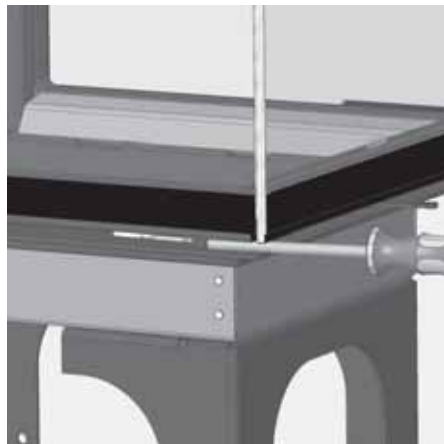
Abb. 4.48 Einsatzstück mit flachem Schraubendreher heraushebeln
