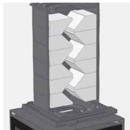
Abb. 4.50 Guss-Speicheraufsatz, Heizgasführung, Schnittdarstellung
