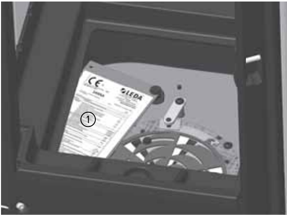
Abb. B.1 Geräteschild / CE-Kennzeichnung auf Trägerblech unterhalb des Brennraums, erreichbar über die Feuertür / den Brennraum
