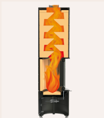
COLONA : Trajectoire des gaz chauds à travers le cœur en chamotte
