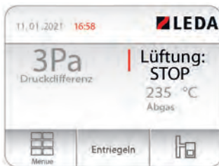
Abb. 7.4 Anzeige bei einer Störung
