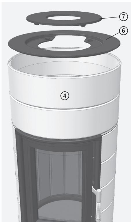
Fig. 3.38 Montage de la rehausse
