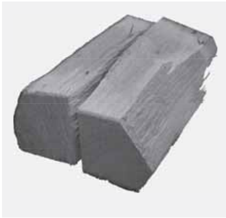
Abb. 4.12 Holzaufgabe mit 2 Holzscheiten – PEPPA (ohne Wassertechnik), Auflage längs im Brennraum
