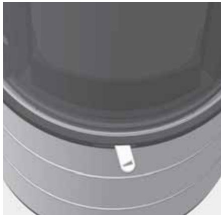
Abb. 4.6 Verbrennungslufthebel ganz rechts, Verbrennungsluft komplett geöffnet, Anheizen
