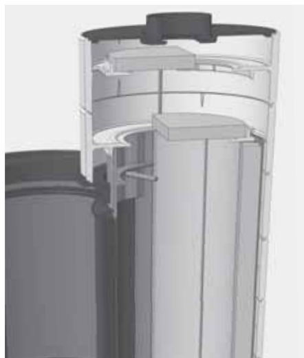
Abb. 4.40 Entnehmen der Umlenkungen (Heizgasführung) – Schnittdarstellung
