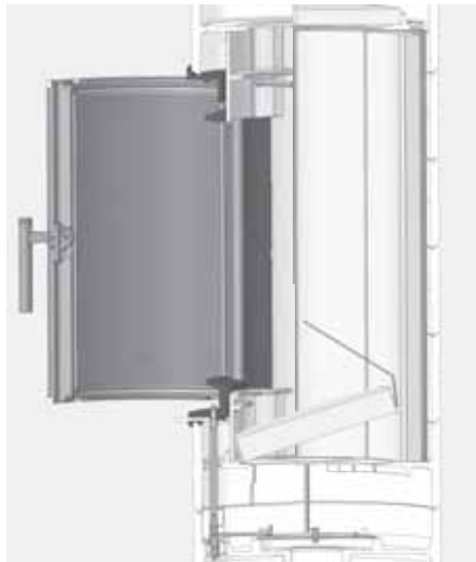
Abb. 4.36 Anheben des Bodensteins im Brennraum
