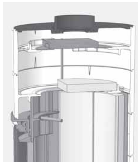
Abb. 4.41 Lage der Katalysatorplatten anstelle der oberen Umlenkung – Schnittdarstellung
