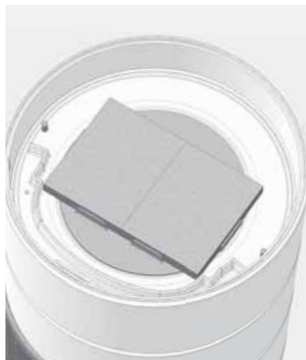
Abb. 6.1 Lage der Katalysatorplatten – Blick von oben ohne Deckplatte
