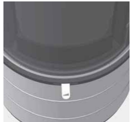
Abb. 4.14 Verbrennungslufthebel ca. 60%, ein kleines Stück rechts der Mitte, Verbrennungsluft auf Nennwärmeleistung
