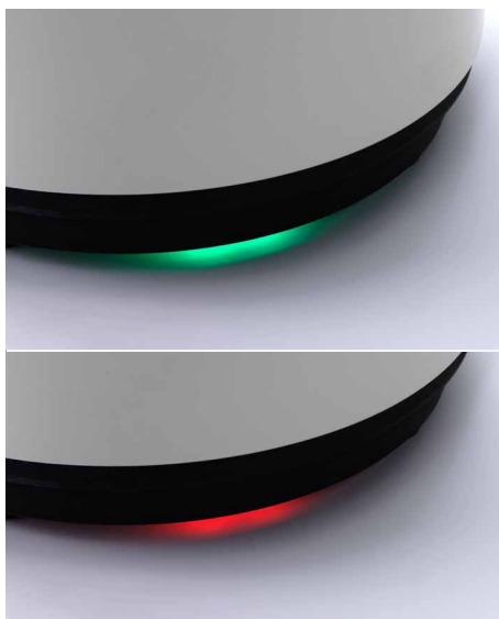
Obr. 4.27 LED signál nejprve „ZELENÝ“, poté „ČERVENÝ“
