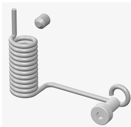
Obr. 3.10 Pružina dveří, stavěcí šroub a připevňovací šroub
