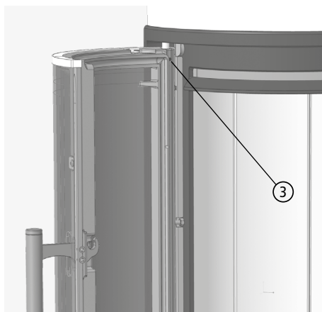
Obr. 3.7 Stavěcí šroub, povolení kuličkové pojistky
