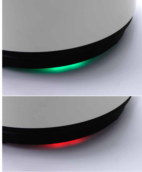
Obr. 4.19 LED signál nejprve „ZELENÝ“, poté „ČERVENÝ“
