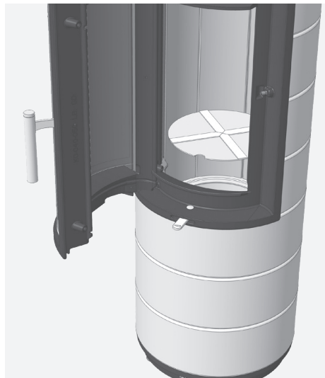
Abb. 4.33 Pohjalevyn irrottaminen tulipesässä
