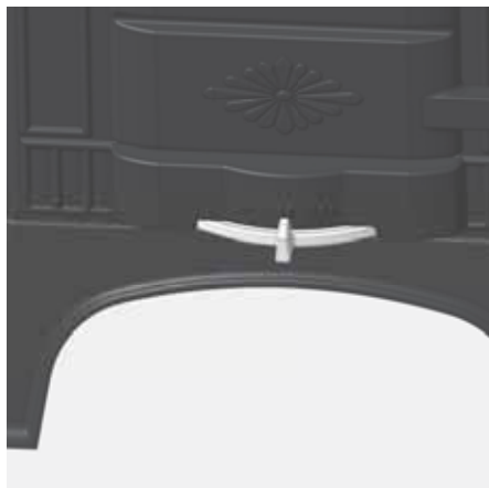
Abb. 4.5 Verbrennungsluftschieber in Mittelstellung, Markierung „II“, Verbrennungsluft für Nennwärmeleistung
