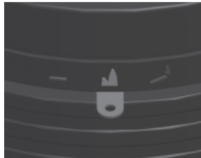
Abb. 4.7 Verbrennungsluftschieber: mittig - Nennwärmeleistung
