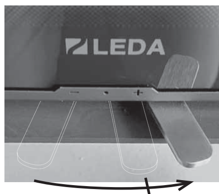
Abb. 4.14 Luftschieber ganz rechts – über den ersten Anschlag hinaus in Anheizstellung – Verbrennungsluft ganz geöffnet (bei FINA plus Luftschieber ganz rechts)
