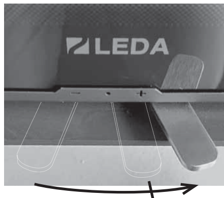
Abb. 4.8 Luftschieber ganz rechts – über den ersten Anschlag hinaus in Anheizstellung – Verbrennungsluft ganz geöffnet (bei FINA plus Luftschieber ganz rechts)
