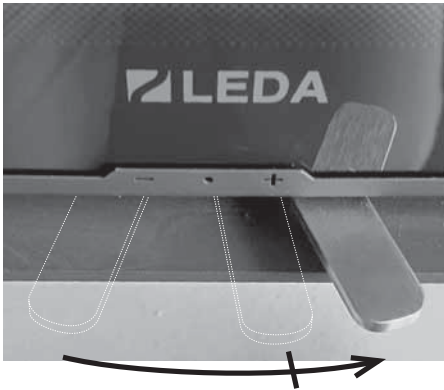
Abb. 4.18 Luftschieber ganz rechts – über den ersten Anschlag hinaus in Anheizstellung – Verbrennungsluft ganz geöffnet (bei FINA plus Luftschieber ganz rechts)
