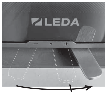
Abb. 4.13 Luftschieber ganz rechts – über den ersten Anschlag hinaus in Anheizstellung – Verbrennungsluft ganz geöffnet (bei FINA plus Luftschieber ganz rechts)
