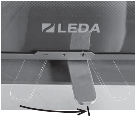
Abb. 4.19 Luftschieber rechts, Symbol „+“, bis Anschlag Verbrennungsluft komplett geöffnet
