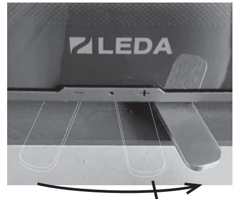
Abb. 4.24 Luftschieber ganz rechts – über den ersten Anschlag hinaus in Anheizstellung – Verbrennungsluft ganz geöffnet (bei FINA plus Luftschieber ganz rechts)
