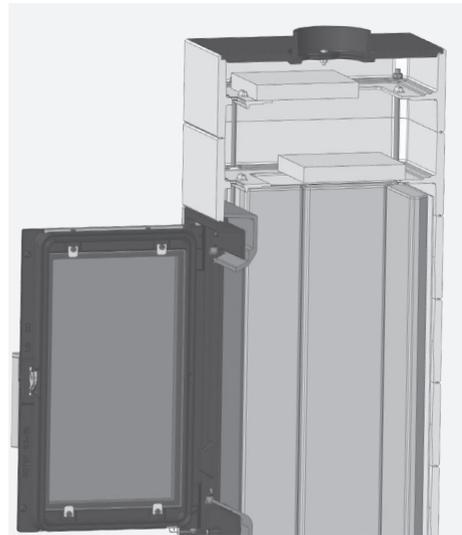
Fig. 4.28 Dépose des déflecteurs (conduite des gaz de chauffage)
