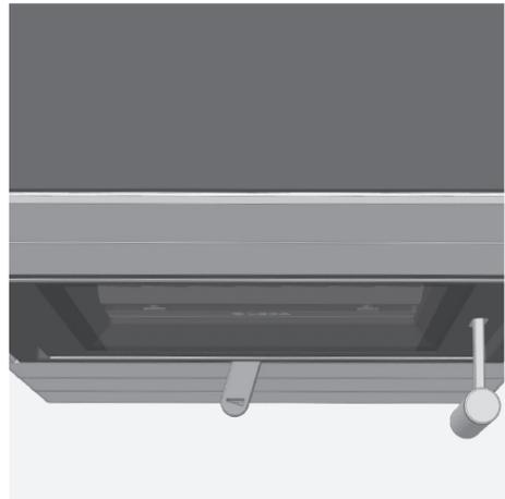
Fig. 4.10 Levier d'air de combustion complètement à gauche, air de combustion fermé
