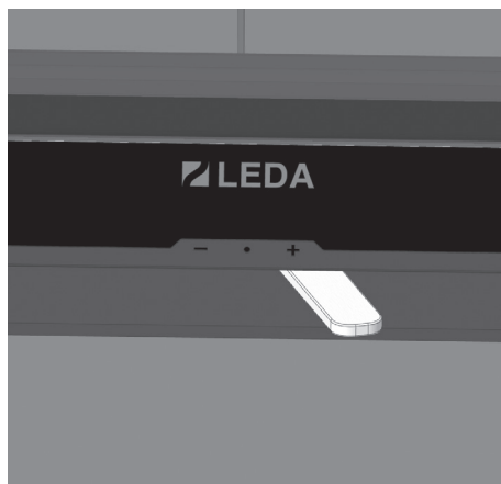
Abb. 1.12 Ilmansäädin oikealla rajoittimeen asti, symboli ”+” korvausilma täysin auki
