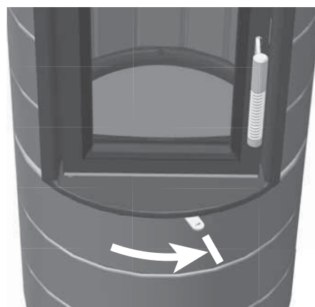
Abb. 4.4 Luftschieber ganz rechts, Verbrennungsluft geöffnet, Betriebsstellung
