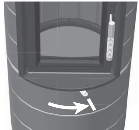
Abb. 4.5 Luftschieber ganz rechts, Verbrennungsluft geöffnet, Betriebsstellung
