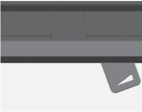
Abb. 7.3 Verbrennungsluftschieber: ganz rechts - Luft ganz geöffnet
