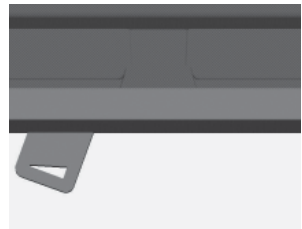
Abb. 7.9 Verbrennungsluftschieber: ganz links - ganz geschlossen
