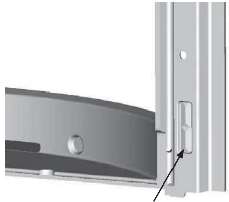
Abb. 4.9 vorgeprägter Ausschnitt im Frontrahmen für den Türschalter
