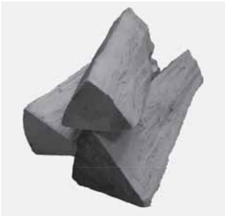
Abb. 4.18 Holzaufgabe bei TURMA DS: 2 Holzseite unten mit ca. 1 cm Abstand längs, das 3. Holzseite schräg darauf Holzaufgabe bei TURMA XL F oder TURMA XL HL: 2 Holzseite unten mit ca. 2 bis 4 cm Abstand längs, das 3. Holzseite schräg darauf
