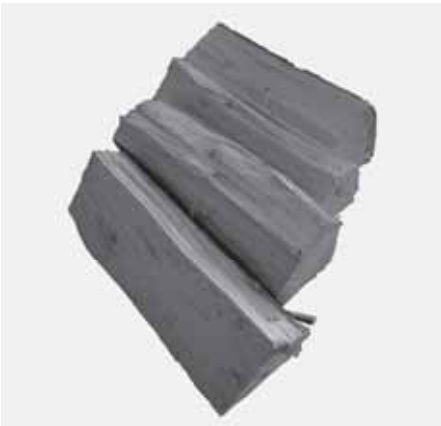
Abb. 4.19 Holzaufgabe bei TURMA XL DS: 4 Holzseite in einer Lage, ohne Abstand zueinander und schräg ausgerichtet
