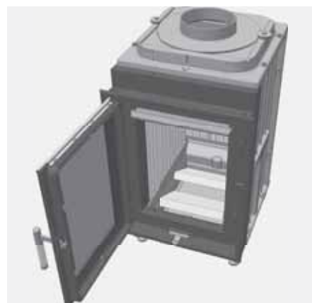
Abb. 4.36 Entnehmen der Bodensteine
