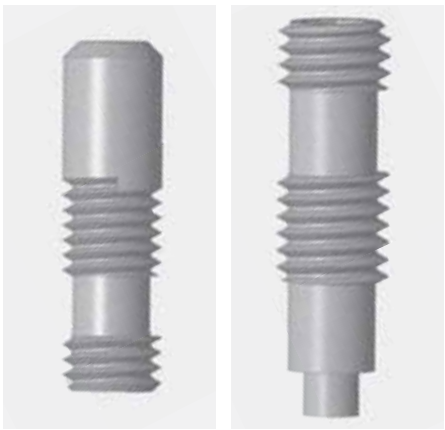
Abb. 5.12 obere Scharnierachse, mit flachem Kopf
