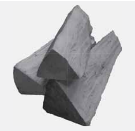
Abb. 4.28 Holzaufgabe mit 3 Holzscheiten bei Speicherleistung – 2 Scheite längs, darüber ein Scheit diagonal
