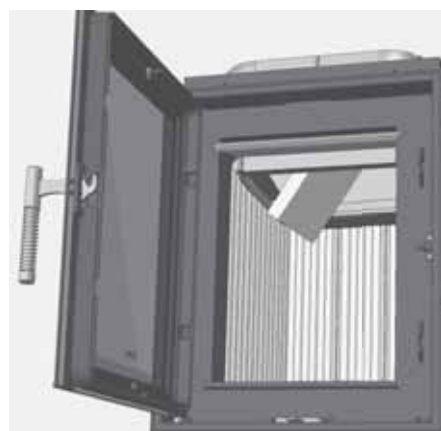
Abb. 4.35 Entnehmen der Umlenkungen
