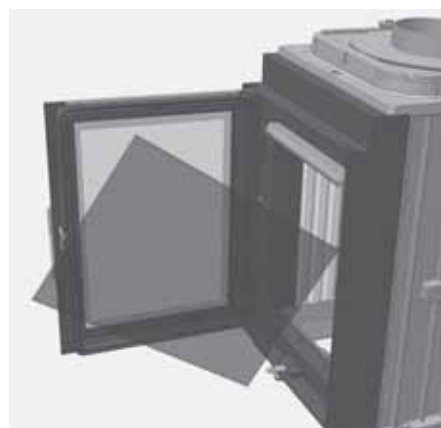
Abb. 4.31 Entnehmen der inneren Sichtscheibe
