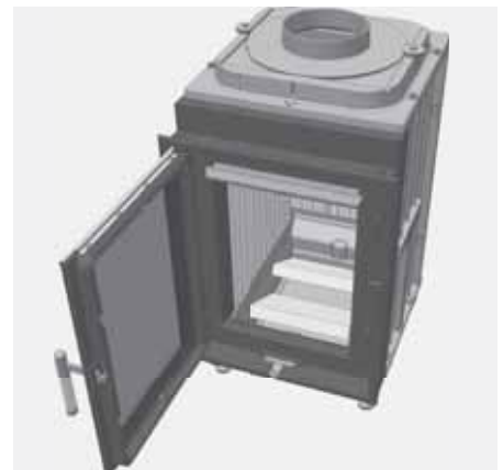
Abb. 4.29 Entnehmen der Bodensteine
