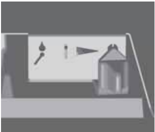
Abb. 4.13 Verbrennungslufthebel: ganz rechts – Luft komplett geschlossen
