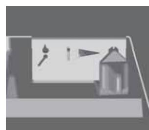
Abb. 4.16 Verbrennungslufthebel: ganz rechts – Luft komplett geschlossen
