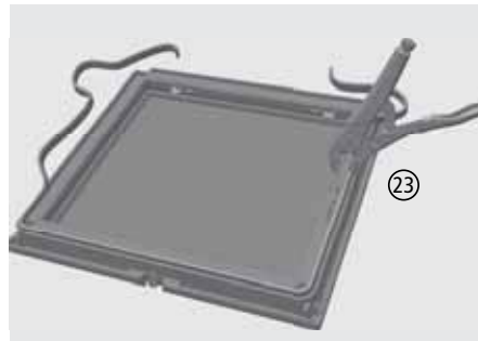
Abb. 4.28 Gripzange rechts ansetzen
