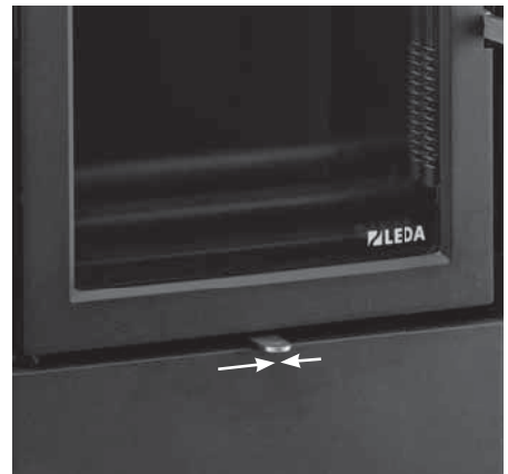
Abb. 4.16 Luftschieber Mitte bis etwas rechts der Mitte – 50 bis 75 %, Betriebsstellung bei Betrieb mit Guss-Heizkasten
