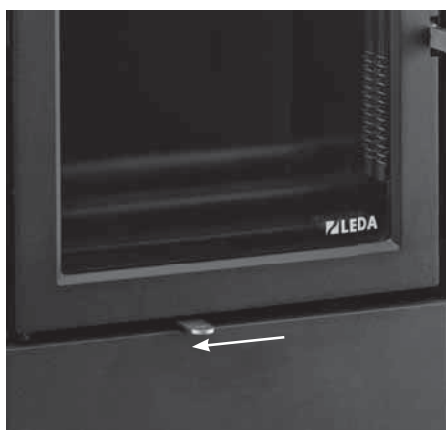
Abb. 4.2 Luftschieber ganz links – 0 %, Verbrennungsluft geschlossen
