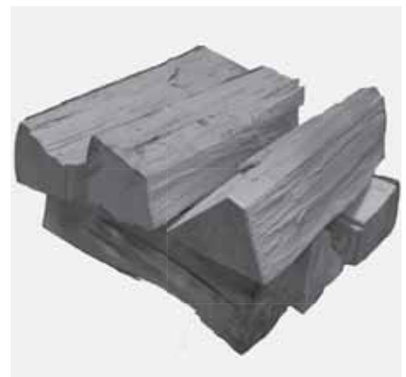
Abb. 4.6 Holzscheite für das Anheizen – ungefähr entsprechend der Holzaufgabe bei Nennwärmeleistung
