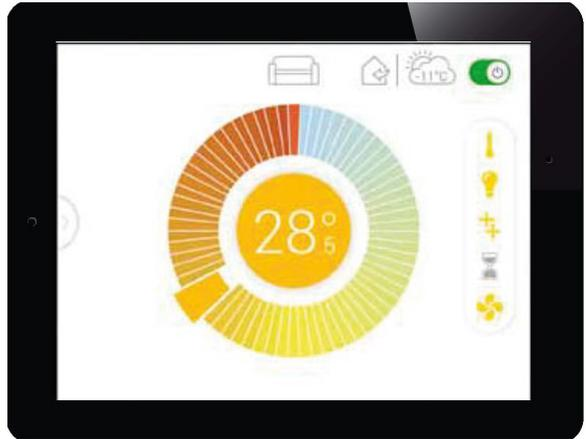
Nach Berühren des Farbkreises wird die neu gewählte Temperatur für 3 Sekunden in der Mitte des Bildschirms angezeigt. Nach 3 Sekunden erscheint wieder die Raumtemperatur. Das Pfeil-Symbol unter- oder oberhalb der Raumtemperatur zeigt an, ob die Flammenhöhe nach oben oder unten reguliert wird..
