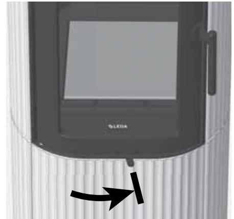
Abb. 4.10 Verbrennungslufthebel ganz rechts, Verbrennungsluft geöffnet, Betriebsstellung
