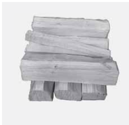
Abb. 4.8 3 dünne Holzstreifen zwischen den beiden äußeren Scheiten in der zweiten Lage (insgesamt ca. 0,3 kg, jeweils ca. 0,10 kg)
