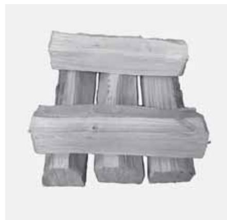
Abb. 4.7 zweite Lage: 2 Scheite, 25 cm Länge bei Durchmesser von 5 cm bis 7 cm, quer zu der ersten Lage (insgesamt 1,2 kg, jeweils ca. 0,60 kg)
