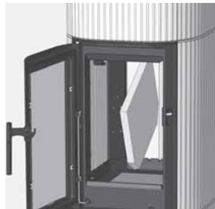
Abb. 4.46 Prallplatte nach vorne gedreht und aus dem Brennraum entnehmen
