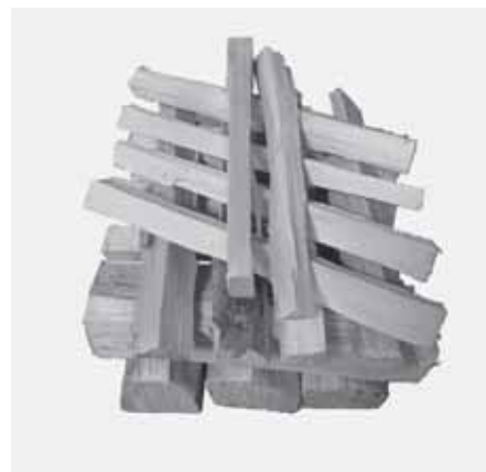
Abb. 4.9 3 zusätzliche Lagen aus dünnen Holzstreifen, Streifen längs, 4 Streifen längs, 4 Streifen diagonal und 2 Streifen längs (insgesamt 10 Streifen, insgesamt 0,8 kg, jeweils ca. 0,08 kg)
