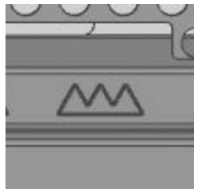
Abb. 4.8 Luftschieber ganz rechts, komplett geöffnet, Anheizstellung
