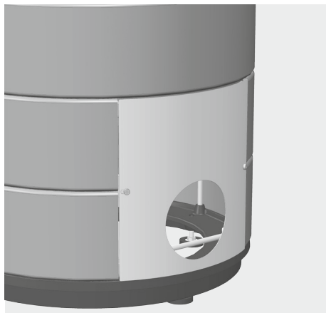
Afb. 3.5 Inspectieplaat achteraan het toestel met kabelvoorziening
