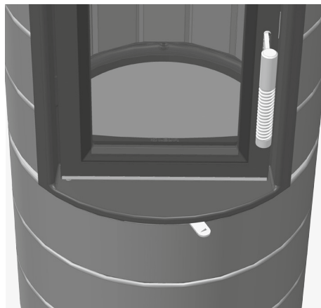
Afb. 4.4 Verbrandingsluchtschuif, rechts, volledig geopend
