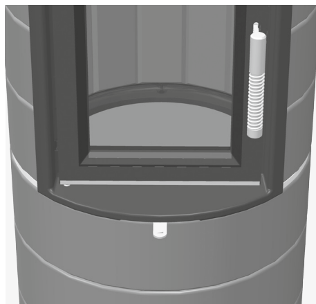
Afb. 4.5 Verbrandingsluchtschuif, midden, gebruik bij nominaal verwarmingsvermogen
