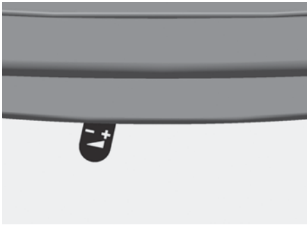
Abb. 4.5 Verbrennungsluft-Schieber ganz links – Verbrennungsluft komplett geschlossen
