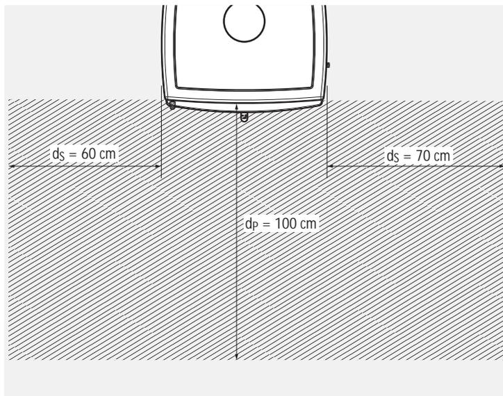
Abb. 2.3 Strahlungsbereich der Sichtscheibe bei ALLEGRA – schematische Darstellung
