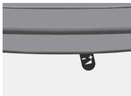
Abb. 4.13 Verbrennungsluft-Schieber ganz rechts – Verbrennungsluft komplett geöffnet
