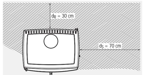
Abb. 2.10 Mindestabstände bei ALLEGRA zu brennbaren Materialien – Seitenabstand rechts
