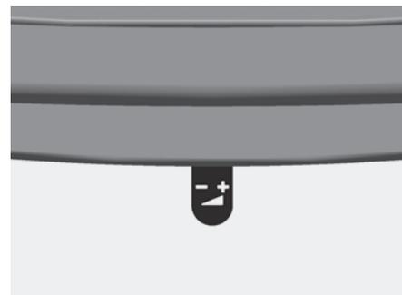
Abb. 4.15 Verbrennungsluft-Schieber mittig – ca. 50% bis 75% geöffnet
