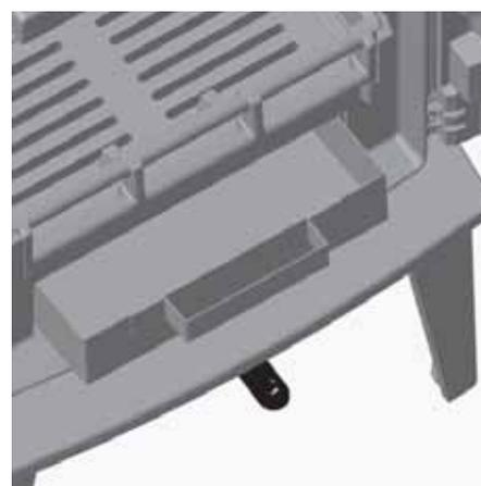
Abb. 4.19 Entnehmen des Aschekastens beim ALLEGRA small
