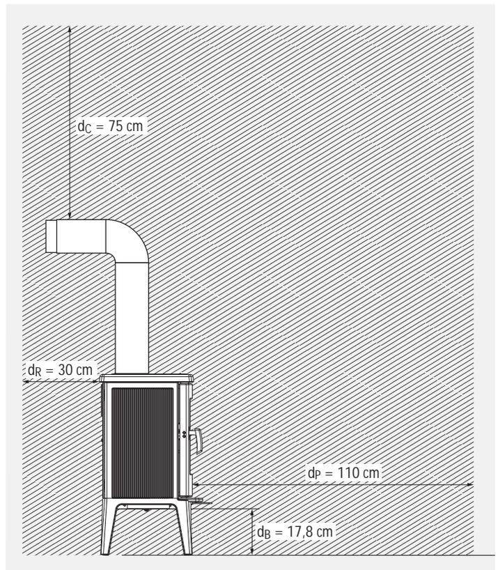
Abb. 2.6 Strahlungsbereich der Sichtscheibe bei ALLEGRA small – schematische Darstellung, Seitenansicht
