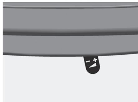
Abb. 4.7 Verbrennungsluft-Schieber ganz rechts –
