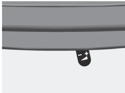
Abb. 4.8 Verbrennungsluft-Schieber ganz rechts – Verbrennungsluft komplett geöffnet
