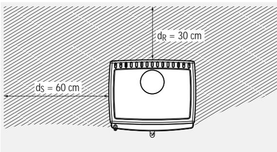
Abb. 2.11 Mindestabstände bei ALLEGRA small oder ALLEGRA small mit Holzfach zu brennbaren Materialien
