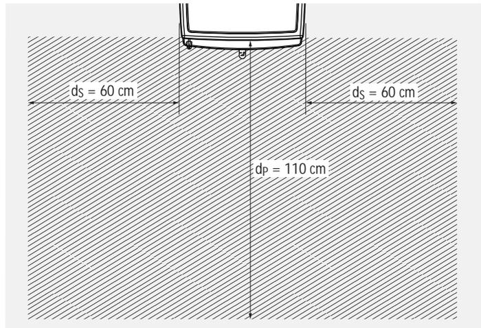
Abb. 2.7 Strahlungsbereich der Sichtscheibe bei ALLEGRA small mit Holzfach – schematische Darstellung
