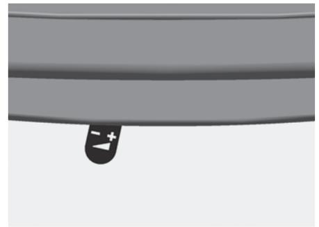
Abb. 4.16 Verbrennungsluft-Schieber ganz links – Verbrennungsluft komplett geschlossen
