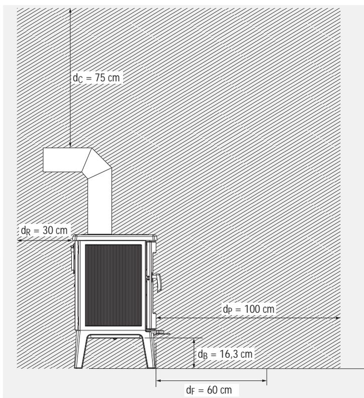
Abb. 2.4 Strahlungsbereich der Sichtscheibe bei ALLEGRA – schematische Darstellung, Seitenansicht
