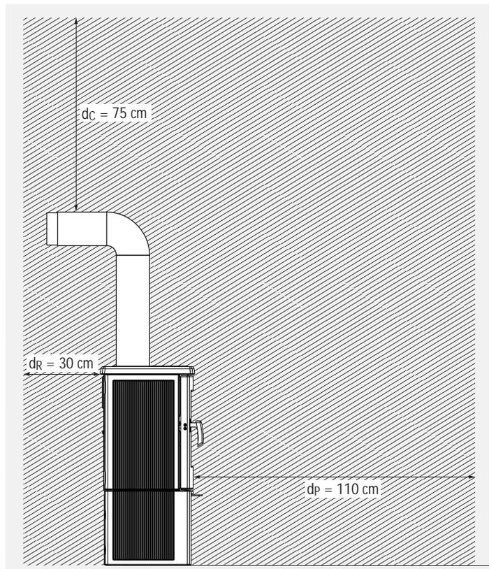
Abb. 2.8 Strahlungsbereich der Sichtscheibe bei ALLEGRA small mit Holzfach – schematische Darstellung, Seitenansicht
