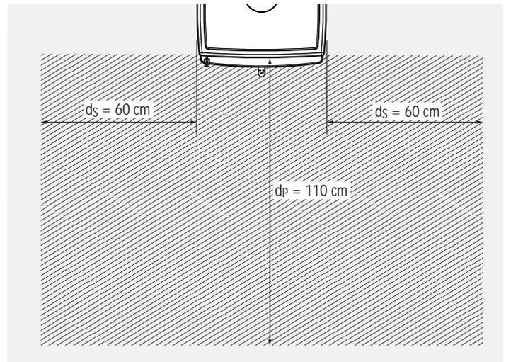
Abb. 2.5 Strahlungsbereich der Sichtscheibe bei ALLEGRA small – schematische Darstellung
