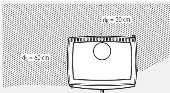
Abb. 2.9 Mindestabstände bei ALLEGRA zu brennbaren Materialien – Seitenabstand links
