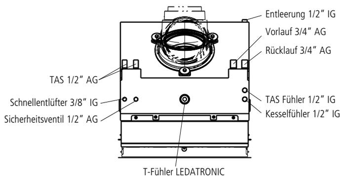
**SERA W DS Anschlüsse** mit Guss-Heizgasstutzen 180 mm (1004-00797)
