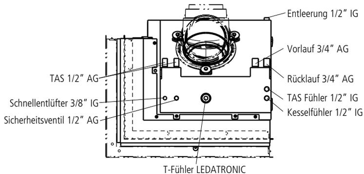
**SERA W ES R Anschlüsse** mit Heizgasstutzen 180 mm (1004-01057)
