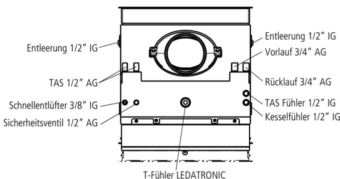
**SERA W ES L Anschlüsse** mit Heizgasstutzen 180 mm (1004-01057)
