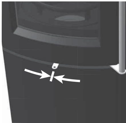
Abb. 4.9 Verbrennungslufthebel mittig, Verbrennungsluft offen, Nennwärmeleistung
