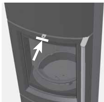
Abb. 4.31 DELTA W: Hebel oberhalb der Feuertür hinein- geschoben – Umlenkschieber komplett geschlossen
