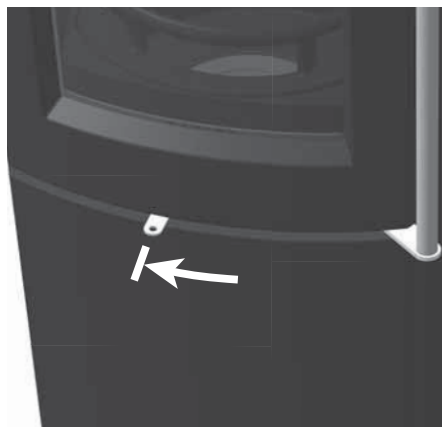
Abb. 4.26 Verbrennungslufthebel ganz links, Verbrennungsluft geschlossen
