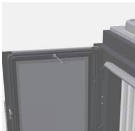
Abb. 4.36 Lösen der Glashalter
