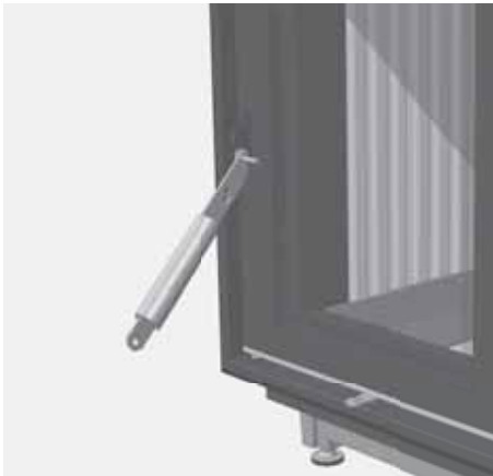
Abb. 3.2 Türverschluss und Bediengriff („kalte Hand“)
