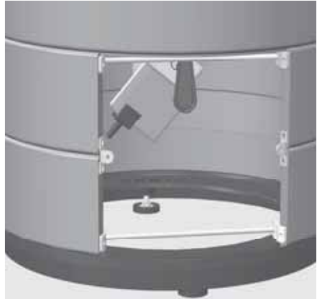
Abb. 3.2 Stellfüße unter dem Geräteboden, abgenommene Abdeckung
