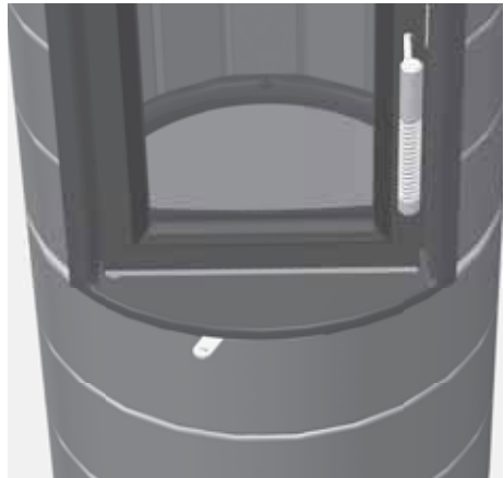
Abb. 4.6 Verbrennungsluft-Schieber, links, ganz geschlossen
