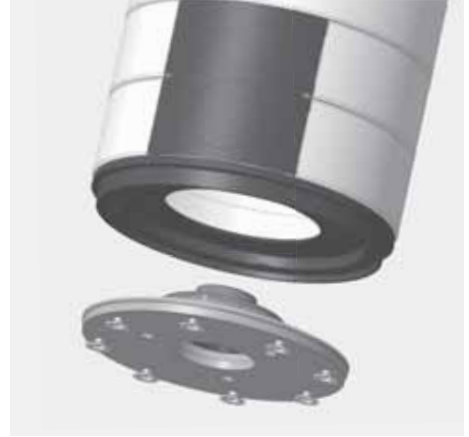
Abb. 3.15 Drehkonsole mit Grundplatte und Oberteil
