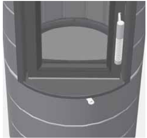
Abb. 4.4 Verbrennungsluft-Schieber, rechts, ganz geöffnet
