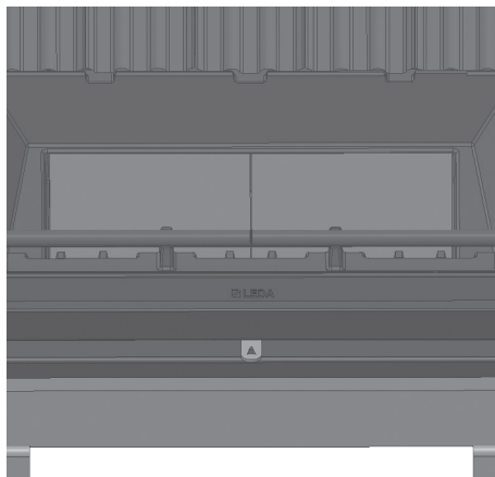
Abb. 1.12 Palamisilman säätöventtiili kokonaan sisällä, kokonaan kiinni.
