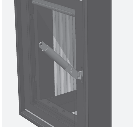
Abb. 1.4 Luukun lukitus ja huoltokahva, saranat vasemmalla, luukunkahva oikealla.
