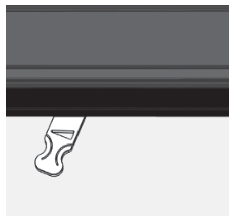
Abb. 4.19 Luftschieber ganz links – 0 %, Verbrennungsluft geschlossen
