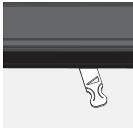
Abb. 4.23 Luftschieber ganz rechts, über den Anschlag hinaus – Anheizstellung, bzw. bei Speicherleistung: komplett geöffnet
