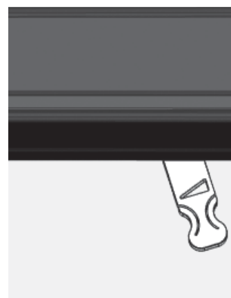
Abb. 4.6 Luftschieber ganz rechts, über den Anschlag hinaus – Anheizstellung, bzw. bei Speicherleistung: komplett geöffnet
