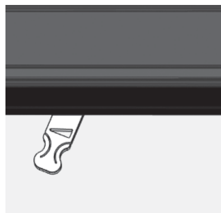
Abb. 4.22 Luftschieber ganz links – 0 %, Verbrennungsluft geschlossen
