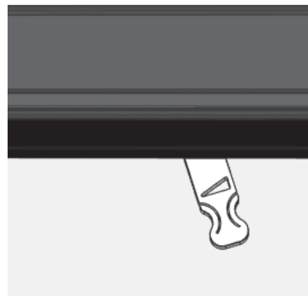
Abb. 4.21 Luftschieber ganz rechts, über den Anschlag hinaus – Verbrennungsluft komplett geöffnet
