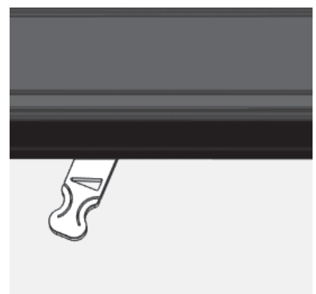
Abb. 4.14 Luftschieber ganz links – 0 %, Verbrennungsluft geschlossen
