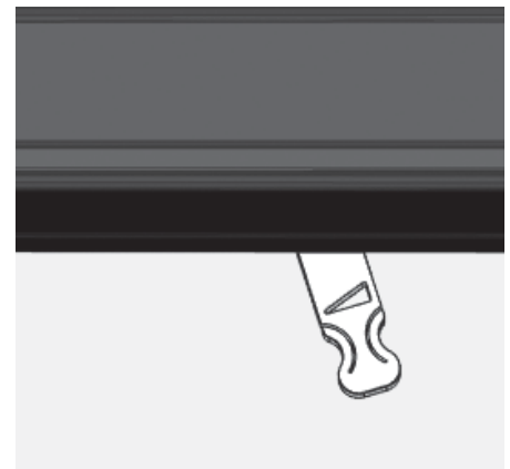
Abb. 4.13 Luftschieber ganz rechts, über den Anschlag hinaus – Anheizstellung, bzw. bei Speicherleistung: komplett geöffnet
