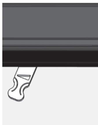
Abb. 4.3 Luftschieber ganz links – 0 %, Verbrennungsluft geschlossen
