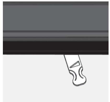
Abb. 4.17 Luftschieber ganz rechts, über den Anschlag hinaus – Anheizstellung, bzw. bei Speicherleistung: komplett geöffnet
