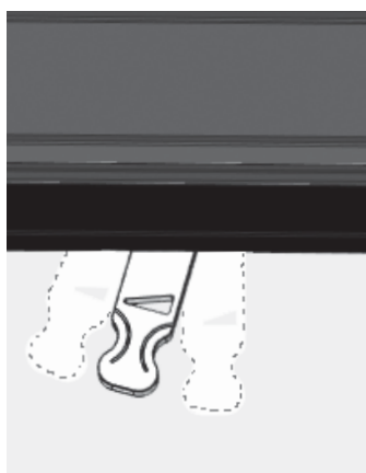
Abb. 4.4 Luftschieber ca. 50 % geöffnet – Verbrennungsluft halb geöffnet, Stellung bei Nennwärmeleistung
