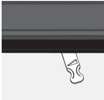
Abb. 4.7 Luftschieber ganz rechts, über den Anschlag hinaus – Anheizstellung, bzw. bei Speicherleistung: komplett geöffnet
