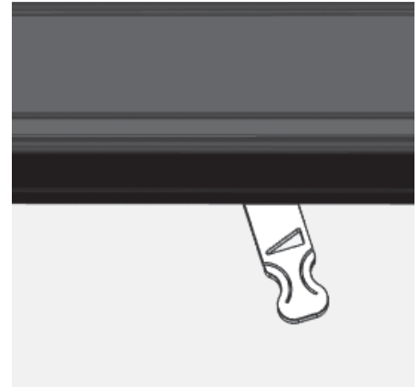
Abb. 4.12 Luftschieber ganz rechts, über den Anschlag hinaus – Anheizstellung, bzw. bei Speicherleistung: komplett geöffnet
