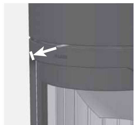
Abb. 4.26 NOVIA W: Hebel oberhalb der Feuertür herausgezogen – Umlenkschieber komplett geöffnet
