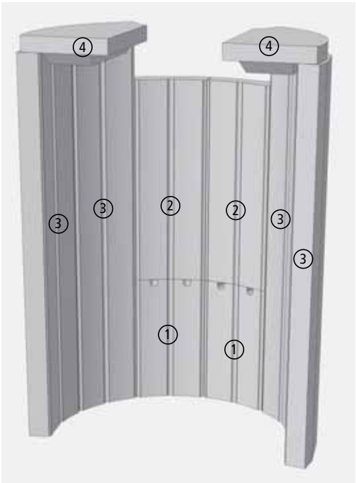
Abb. 5.1 Feuerraum-Auskleidung, NOVIA C, NOVIA CL und NOVIA plus
