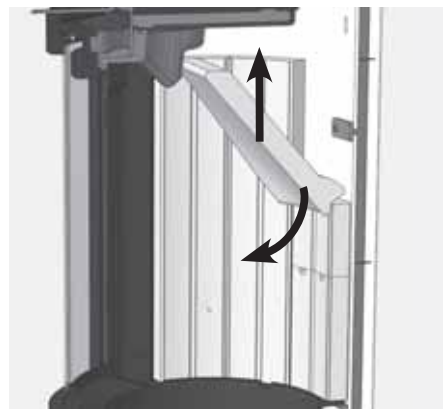
Abb. 4.50 Umlenkung entnehmen – NOVIA W
