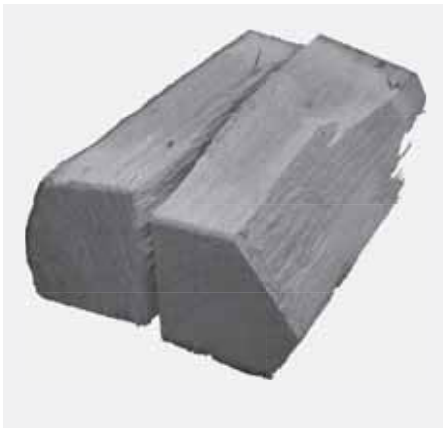
Abb. 4.28 Holzaufgabe mit 2 Holzscheiten – NOVIA C (ohne Wassertechnik), Auflage längs im Brennraum
