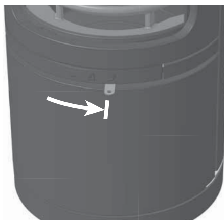
Abb. 4.16 Verbrennungslufthebel ganz rechts, Anheizstellung
