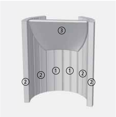
Abb. 5.3 Feuerraumauskleidung, NOVIA W
