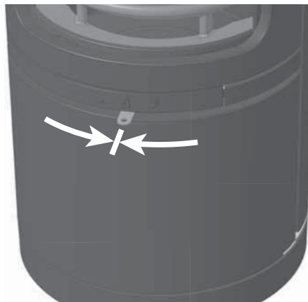
Abb. 4.11 Verbrennungslufthebel ungefähr 1/3 bis mittig, Verbrennungsluft offen, Nennwärmeleistung
