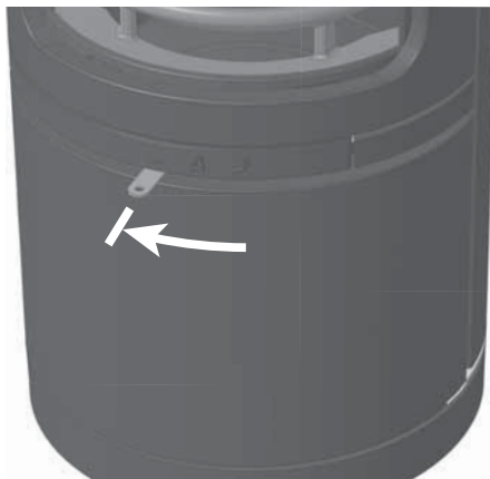
Abb. 4.10 Verbrennungslufthebel ganz links, Verbrennungsluft geschlossen
