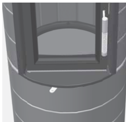
Abb. 4.10 Verbrennungsluft-Schieber, links, ganz geschlossen
