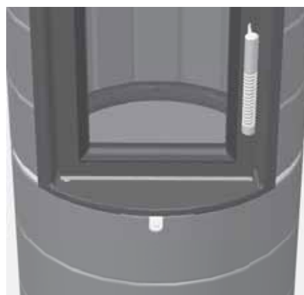
Abb. 4.13 Verbrennungsluft-Schieber, in der Mitte, Betrieb bei Nennwärmeleistung
