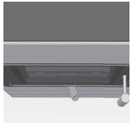
Abb. 4.7 Verbrennungslufthebel ganz rechts, Verbrennungsluft komplett geöffnet, Anheizen
