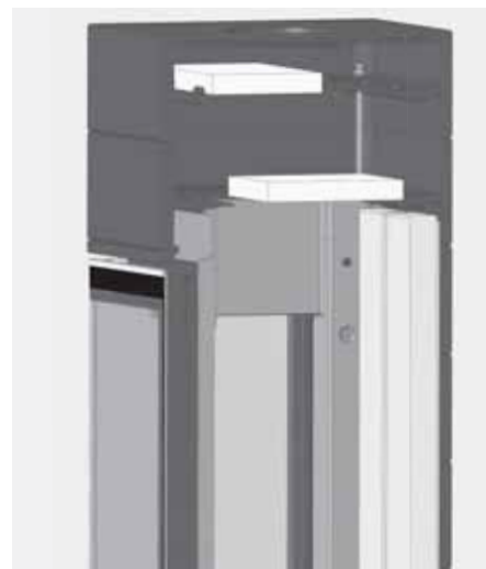
Abb. 7.9 Entnehmen der Umlenkungen (CORNA ES, Heizgasführung)
