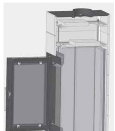
Abb. 4.37 Entnehmen der Umlenkungen (CORNA, Heizgasführung)
