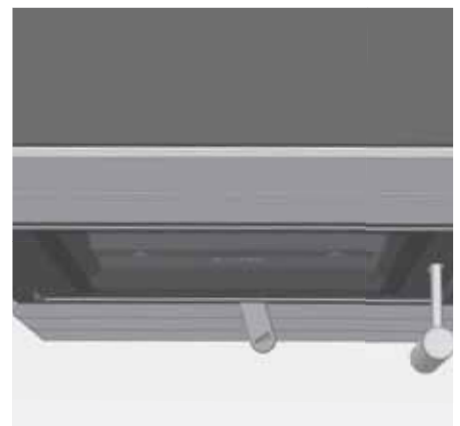
Abb. 4.14 Verbrennungslufthebel ganz rechts, Verbrennungsluft komplett geöffnet, Anheizen
