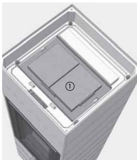
Abb. 4.40 Lage der Katalysatorplatten beim CORNA tec
