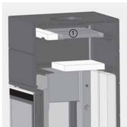
Abb. 4.41 Lage des Katalysators beim CORNA ES tec, Schnittdarstellung
