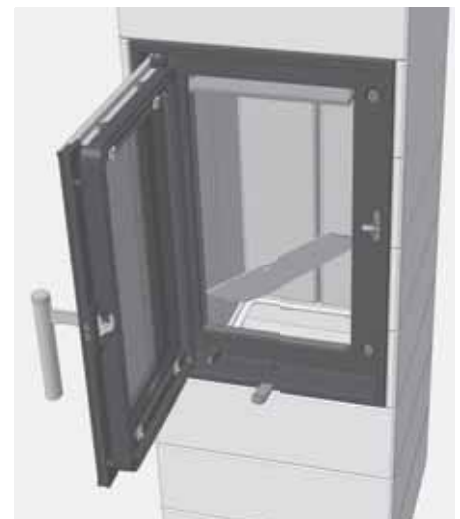
Abb. 4.36 Entnehmen des Bodenblechs im Brennraum
