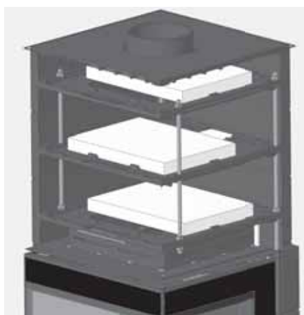
Abb. 4.38 Lage der Umlenkungen beim CORNA PS
