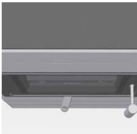
Abb. 4.15 Verbrennungslufthebel ganz links, Verbrennungsluft geschlossen
