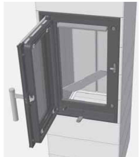
Abb. 4.41 Entnehmen des Bodenblechs im Brennraum
