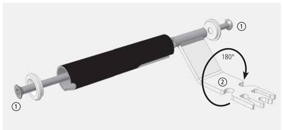
Abb. 4.8 abnehmbarer Türgriff des CORNA PS
