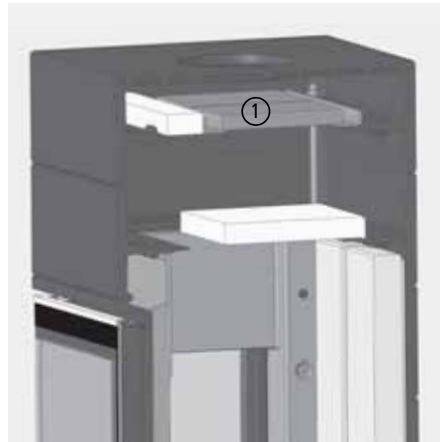
Abb. 4.47 Lage des Katalysators beim CORNA ES, Schnittdarstellung
