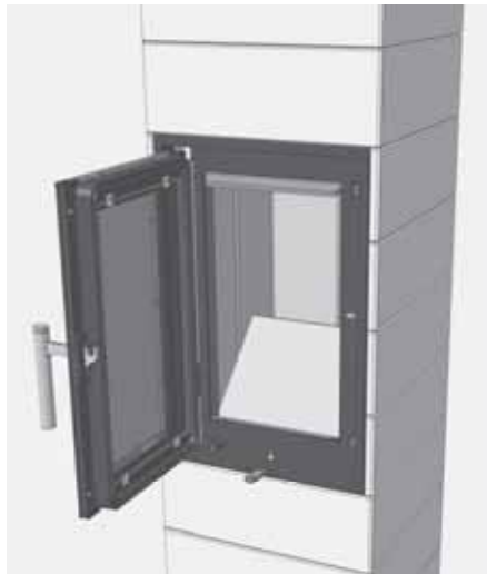
Abb. 4.40 Entnehmen des Bodensteins im Brennraum
