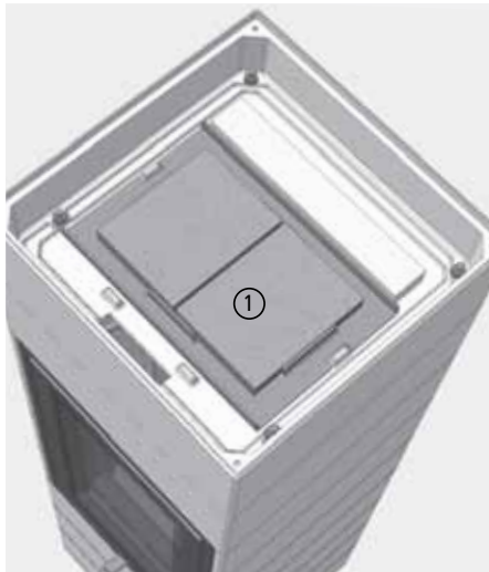
Abb. 4.46 Lage der Katalysatorplatten beim CORNA
