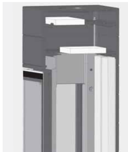
Abb. 4.43 Entnehmen der Umlenkungen (CORNA ES, Heizgasführung)
