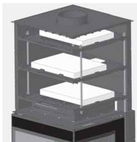
Abb. 4.44 Lage der Umlenkungen beim CORNA PS
