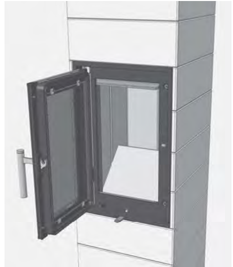
Afb. 4.28 Wegnemen van de bodemsteen in de brandkamer
