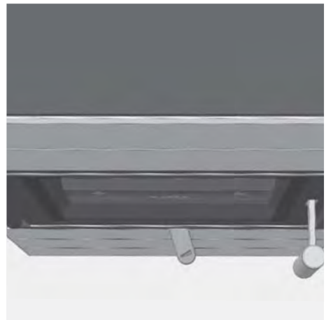
Afb. 4.6 Verbrandingsluchthendel helemaal rechts, verbrandingsluchtoevoer volledig open, aanmaken
