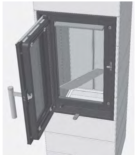
Afb. 4.29 Wegnemen van de bodemplaat in de brandkamer
