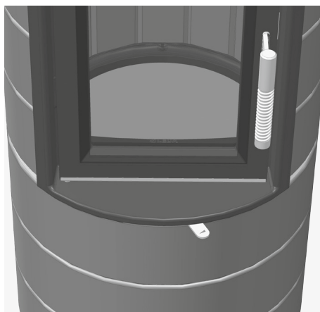
Afb. 4.4 verbrandingsluchtschuif, rechts, helemaal geopend
