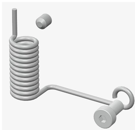
Afb. 3.6 deurveer, stelschroef en spanschroef
