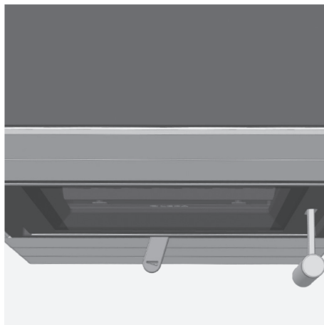
Abb. 4.10 Palamisilman säätöventtiili täysin vasemmalla, palamisilma suljettu.
