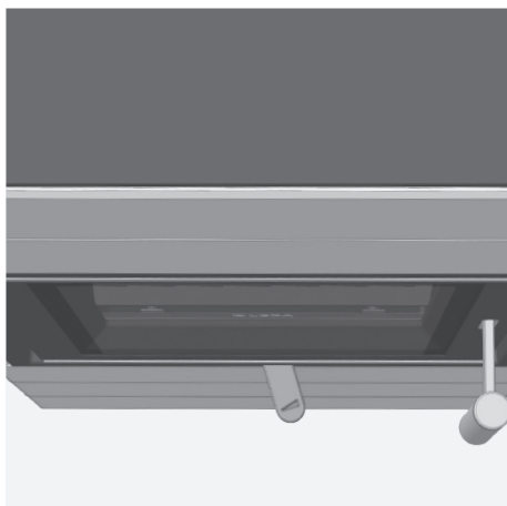
Abb. 4.4 Palamisilman säätöventtiili täysin oikealla, palamisilma täysin auki, sytytys.
