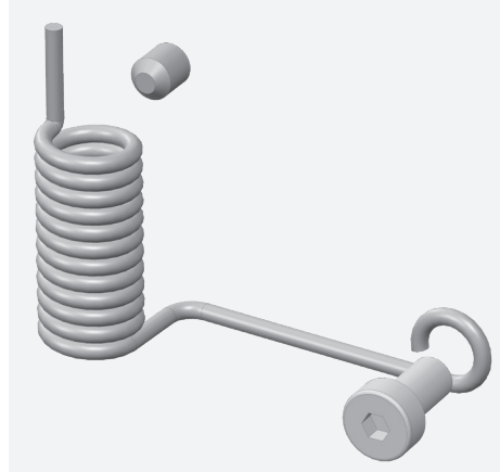
Abb. 3.5 Oven jousi, lukitusruuvi ja kiinnitysruuvi.
